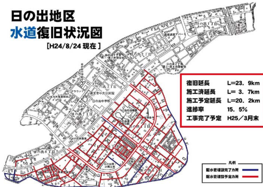
図Ⅱ-4 日の出地区 水道復旧状況図
